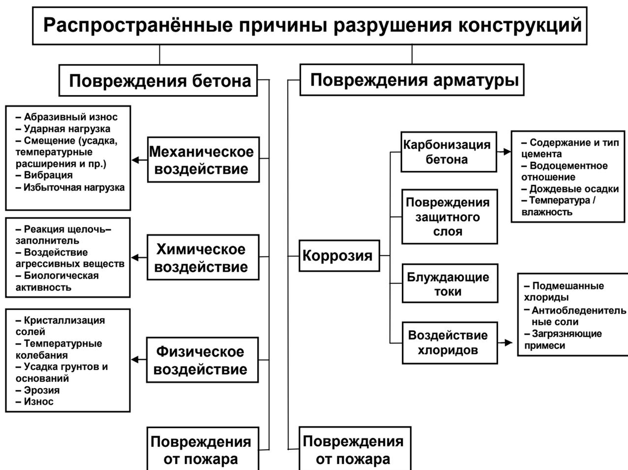
Рисунок 5.2 – Распространённые причины разрушений конструкций
